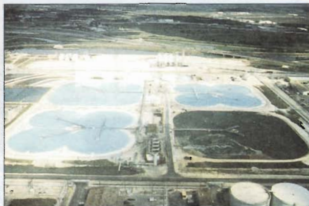
El hidróxido de magnesio se obtiene del agua de mar en los depósitos contruidos por la Dow Chemical Company, en Freeport, Texas.
